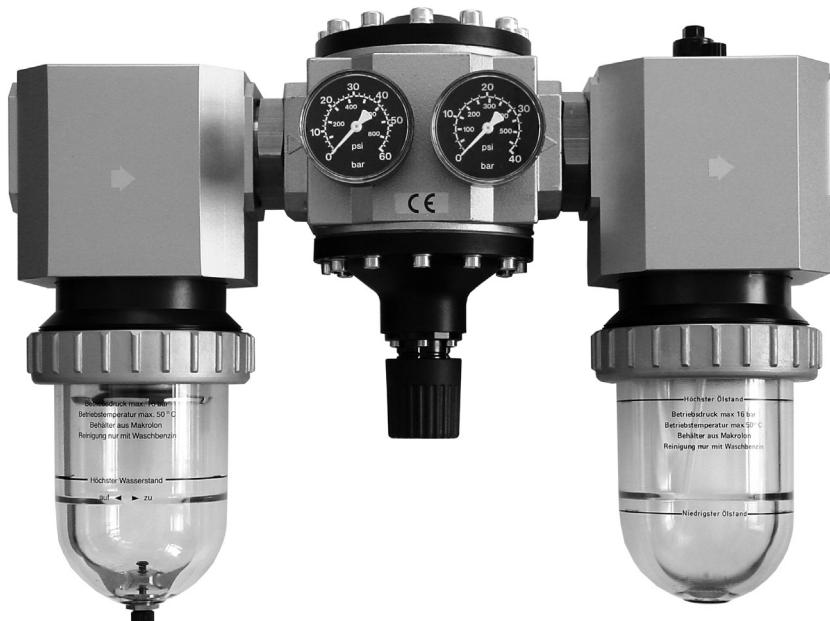
**Wartungseinheiten**, aus Filter-Druckregler-Öl bestehend, haben die Aufgabe, Druckluft als Betriebsmittel von flüssigen und festen Bestandteilen zu reinigen, den Luftdruck zu regeln und die Luft mit feinst vernebeltem Öl zur Schmierung von Zylindern, Ventilen, druckluftgesteuerten Werkzeugen und dergleichen zu durchsetzen.
